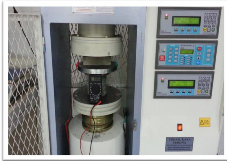
Şekil 1: Elektrik Ölçüm Deneyi Düzeneği
