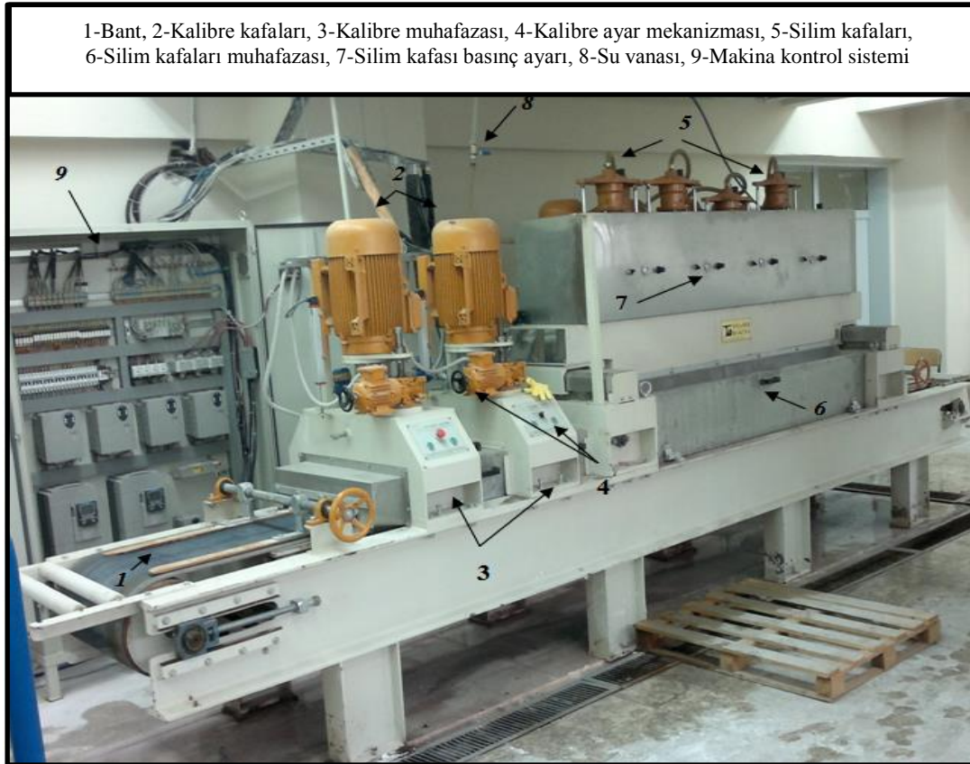
Şekil 1. Aşındırma-cilalama makinası
