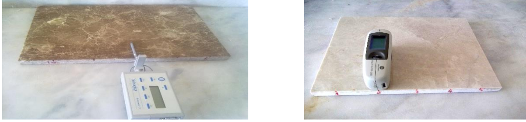
Şekil 2. Yüzey pürüzlülük ve parlaklık ölçümü
