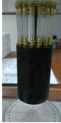
Resim 1. Dairesel sonlu silindir model (önden görünüş).
