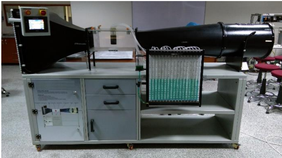
Resim 2. Açık devreli ve emişli tip rüzgâr tüneli.
