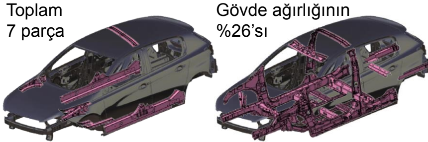
Şekil 3. Peugeot 308'de DP çeliği kullanımı: (a) 2008 model 1. nesil, (b) 2014 model 2. nesil [14].
