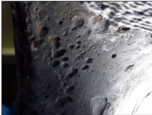
Şekil 4. Orta dereceli sıcaklıkta oksidasyona maruz kalan yapısal bir MoSi 2 parçanın yüzey görüntüsü
