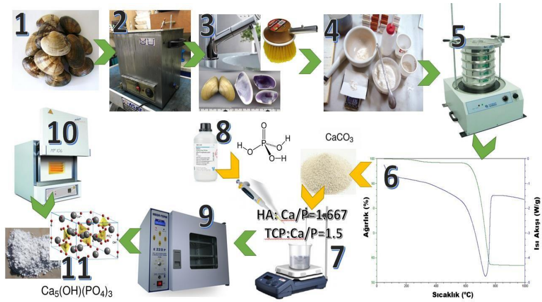
Şekil 4. Deniz kabuklarından biyoseramik sentez aşamaları; 1. Donax trunculus deniz kabukları, 2. Ultrasonik banyo ile temizleme işlemi, 3. Deniz kabuklarının fırça ile çeşme suyunda yıkanması, 4. Temizlenen deniz kabuklarının seramik havanda öğütülmesi, 5. Öğütülen deniz kabuklarının elekten elenerek standart toz boyutuna getirilmesi, 6. Donax trunculus deniz kabuğuna ait TGA grafiği, \text{CaCO}_3 miktarının belirlenmesi, 7. Çözeltinin oluşturulması, 8. Stokiyometrik mol oranına göre \text{H}_3\text{PO}_4 miktarı hesabı ve damla damla karışmakta olan çözeltilere ilave edilmesi, 9. Oluşan çözeltilerin etüvde kurutulması ve çökeltinin sıvıdan uzaklaştırılması, 10. Çökeltinin 450^\circ\text{C} ve 850^\circ\text{C} sıcaklıklarında sinterlenmesi işlemi, 11. DKSHA biyoseramik eldesi ve kimyasal bileşimi.
